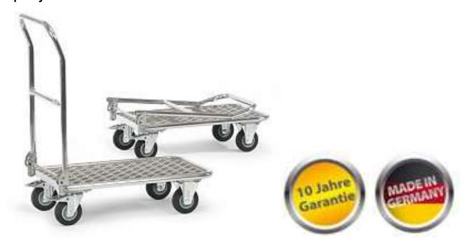
Тележка изготовлена из алюминиевых труб и профилированных алюминиевых деталей. Платформа тележки изготовлена из алюминия. Толкательная ручка складывается на платформу. 2 управляемых и 2 не управляемых колеса изготовленных из целиковой резины. Диски колес вращаются на роликовых подшипниках. Тормоза только на управляемых колесах. Тележка соответствует всем строгим требования европейских норм по надежности EN 1757-3.
