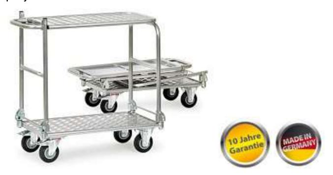
Тележка изготовлена из алюминиевых труб и профилированных деталей. Платформы тележки изготовлены из алюминия. Две толкательные ручки складывается на платформу. Вторая полка так же складывается на нижнюю платформу. 2 управляемых и 2 не управляемых колеса изготовленных из целиковой резины. Диски колес вращаются на роликовых подшипниках. Тормоза только на управляемых колесах. Тележка соответствует всем строгим требования европейских норм по надежности EN 1757-3.
