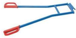
Подобная штанга может использоваться в любой тележке, предназначенной для транспортировки бытовой техники. Состоит из 2-х трубных рычагов с подъемным крюком. Эти изделия сварены вместе в одну конструкцию с поперечиной. Высококачественное, порошковое покрытие бриллиантово-си него цвета в соответствии RAL 5007 гарантирующее длитель ную эксплуатацию без царапин и сколов на поверхности.
