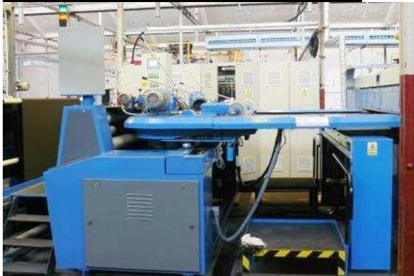
Входные шкафы машины предназначены для заправки товара в главную цепь СШМ. Оснащены направляющими валиками, валиковым расправителем утка, ширильными валиками, тягучим валиком, системой направки и заправки товара в цепь. На данной фотографии Вы можете увидеть пример входных шкафов.
