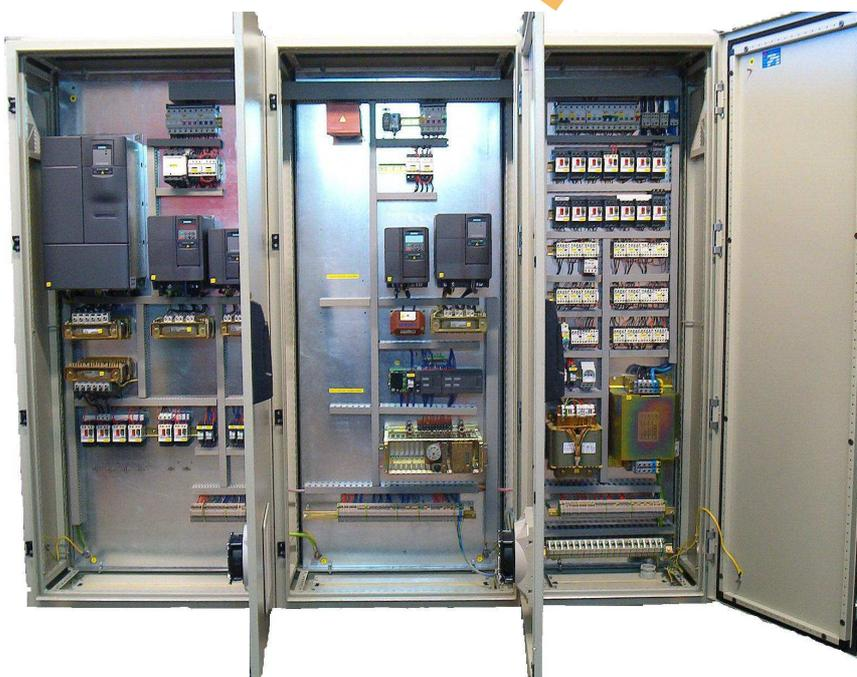
Электронное оборудование машины изготовлено на базе асинхронных двигателей, управляемых преобразователями частоты «SIEMENS» и ПЛЦ «SIMATIC».
