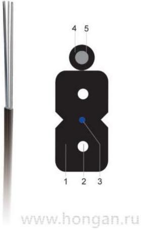
Абонентский дроп-кабель для подвеса между зданиями и сооружениями, абонентских (FTTH/FTTD) и пассивных оптических сетей (PON). По требованию заказчика дроп-кабель может иметь оптический коммуникационный компонент из 1, 2, 3 или 4 одномодовых оптических волокна, либо ленточное волокно (4 или 8 ОВ) стандарта G.652B, G.652D, G.652D-LL, G.657A1 или G.657A2.
